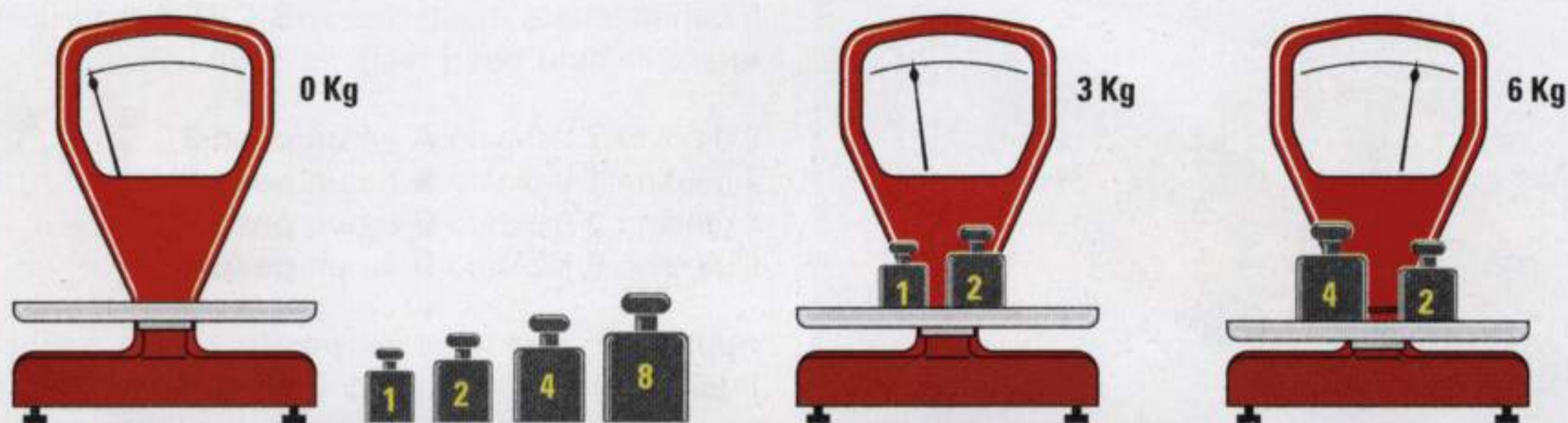
Fig.617 Con questi soli quattro pesi 1-2-4-8 è possibile far apparire sui display tutti i numeri da 0 a 9. Ammesso di avere una bilancia e quattro pesi da 1-2-4-8 Kg, per ottenere 3 Kg sarà sufficiente porre sul piatto un peso da 1 Kg ed uno da 2 Kg. Per ottenere 6 Kg sarà sufficiente collocare sul piatto un peso da 2 Kg ed uno da 4 Kg, mentre per ottenere 9 Kg sarà sufficiente porre sul piatto un peso da 1 Kg ed uno da 8 Kg.
