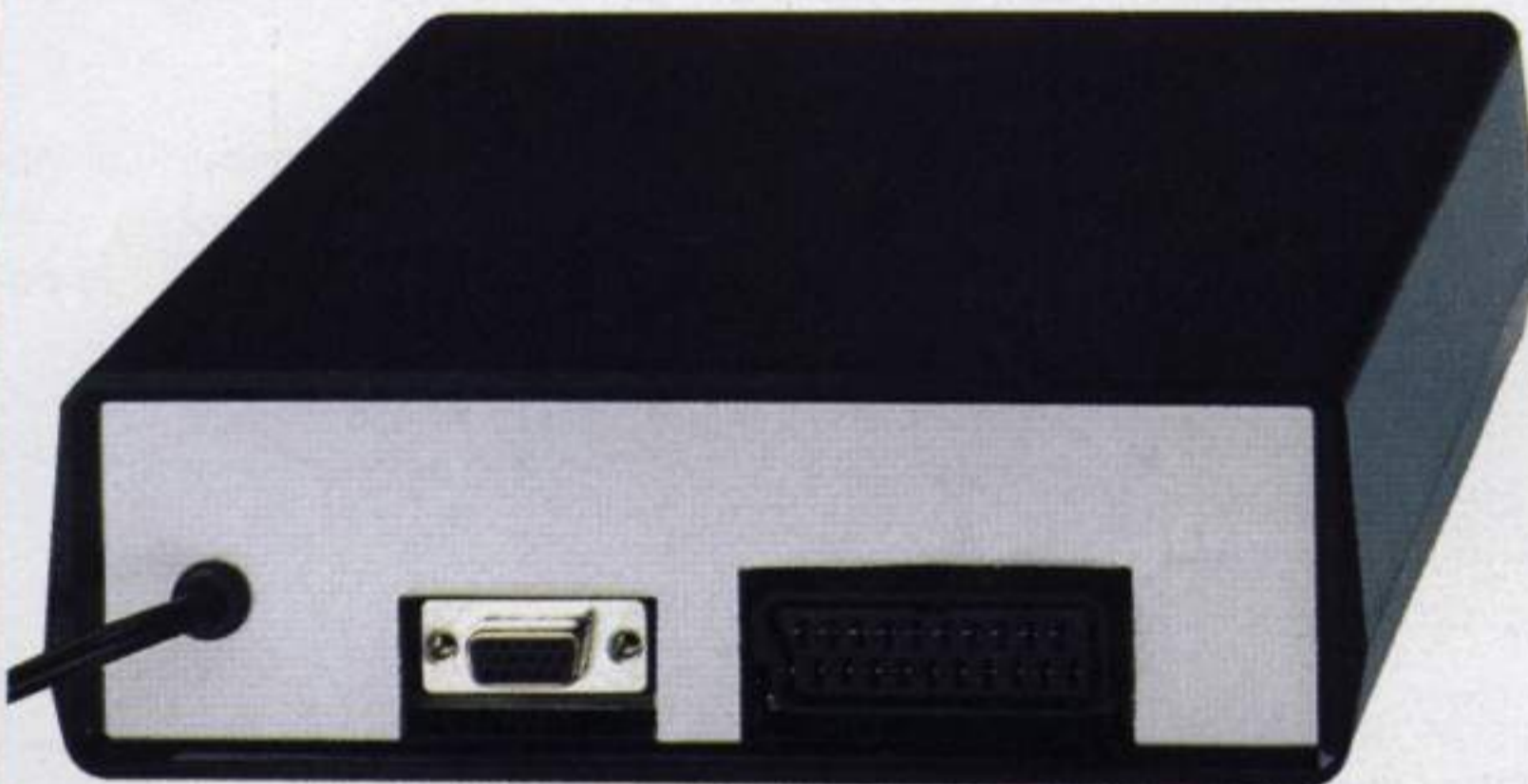
Fig.8 Guardando il pannello posteriore del mobile, a sinistra c'è la presa per i monitor dei PC e a destra la presa Scart TV.
