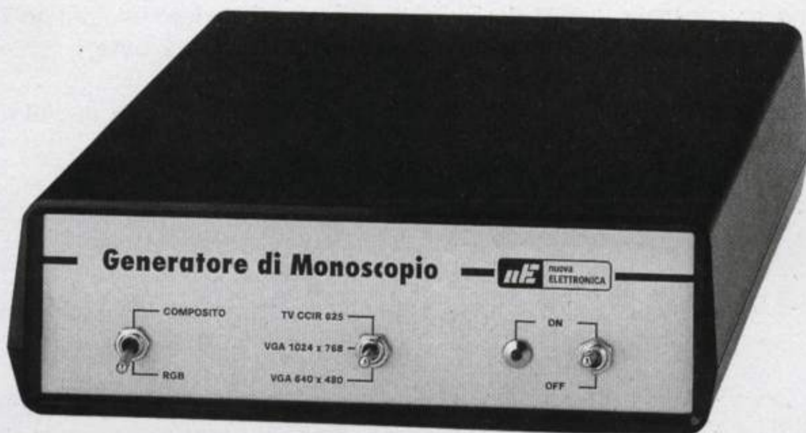
Fig.2 Come si presenta il pannello frontale del Generatore di monoscopio per televisori e monitor VGA.
